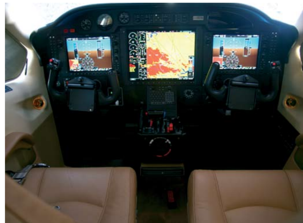
O painel Garmin G1000 com três enormes telas é para míope não reclamar. Na página ao lado, é visível o tamanho do nariz do TBM850 com relação ao resto da aeronave.
