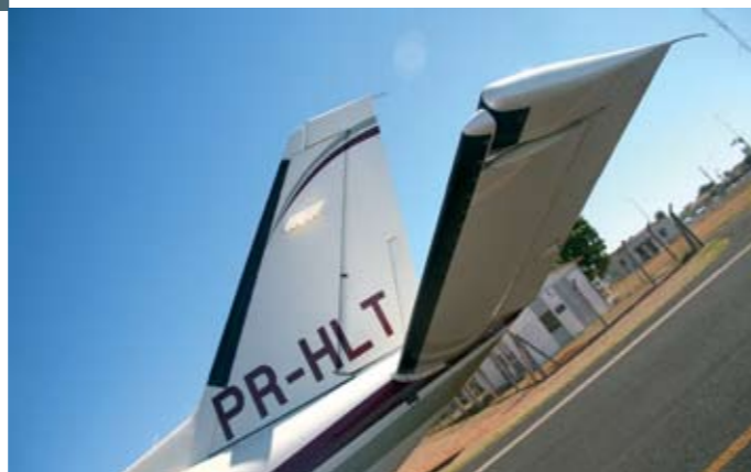
A porta abre para o generoso espaço de cabine. Abaixo, uma das características dos modelos Socata, o conjunto da empenagem com o profundor bem atrasado.
