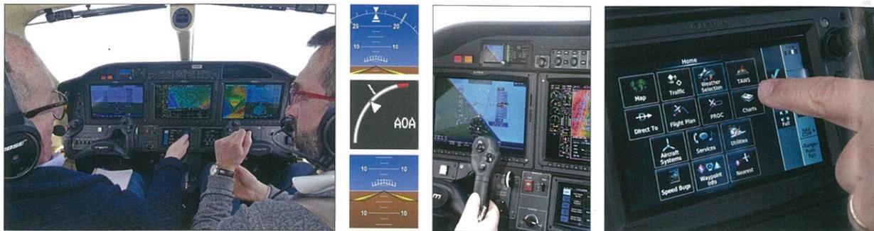
Roll Limit Indicator, Angle of Attack Indicator et Pitch Limit Indicator (écrans au centre).
