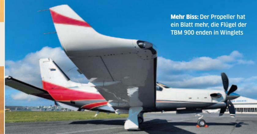
**Mehr Biss:** Der Propeller hat ein Blatt mehr, die Flügel der TBM 900 enden in Winglets
