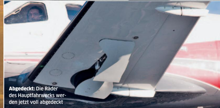
**Abgedeckt:** Die Räder des Hauptfahrwerks werden jetzt voll abgedeckt
