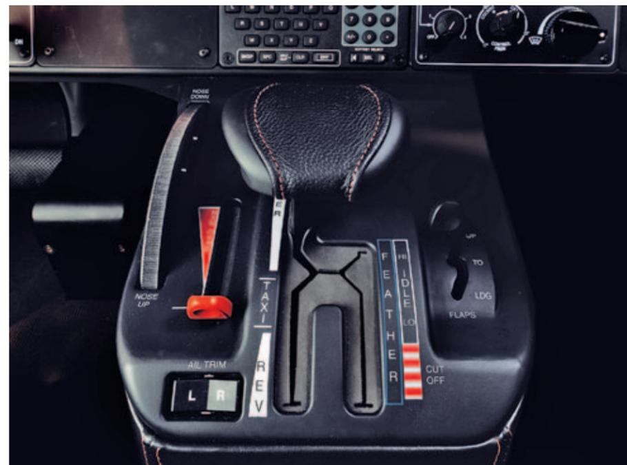
**Nur noch ein Hebel:** Dank einer H-förmigen Führung genügt ein Bedienhebel für die gesamte Triebwerkseinstellung, also Leistung, Propeller-Drehzahl und Gemisch-Aufbereitung
