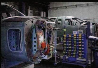
La phase de pré-assemblage consiste à poser les câbles et les éléments de tuyauterie. Le capot moteur puis la voilure sont fixés à l'avion qui part à l'atelier de peinture.
