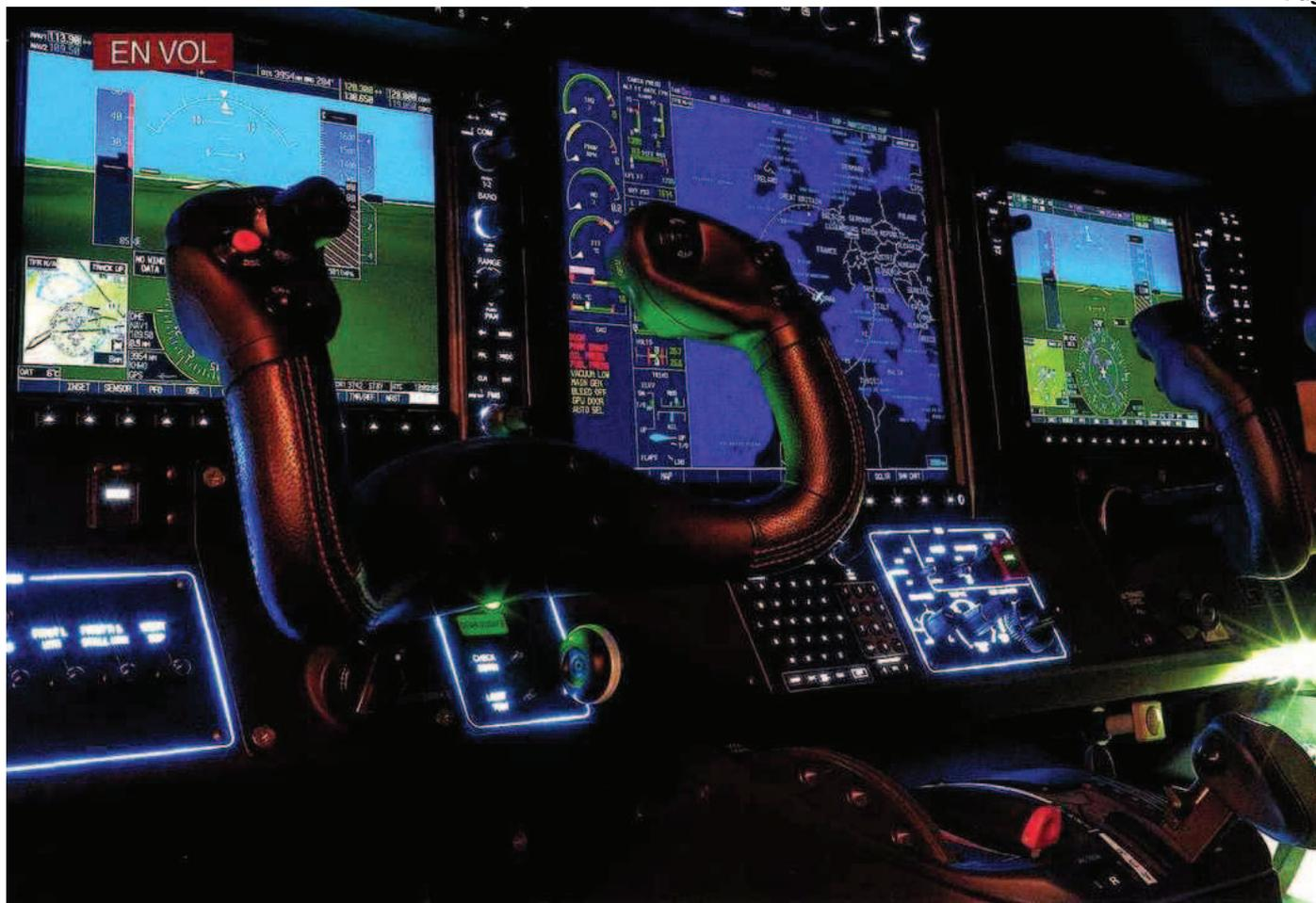
Le G1000 a été programmé pour gérer la turbine facilement, le manche a plus de commandes, la manette moteur est unique, la pressu automatique, le démarrage semi-automatique, etc.
