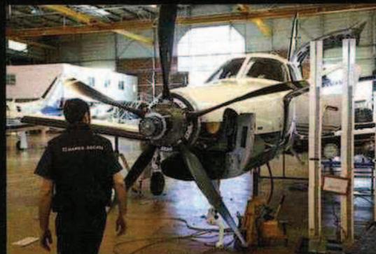
Comme ses prédécesseurs, le TBM 900 est muni d'un moteur fourni par la filiale canadienne de l'américain Pratt & Whitney. Les pales de l'hélice sont en composites renforcés de fibres de carbone.
