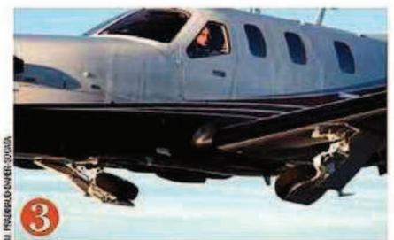
Daher-Socata a intégré des « winglets », une nouvelle hélice et une nouvelle prise d'air ①, une monomanette ② et des trappes de train redessinées ③.
