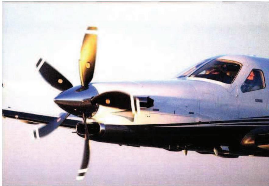
Nouvelle hélice Hartzell 5 pales, nouveau capot moteur pour optimiser les écoulements aérodynamiques, nouvelle entrée d'air, nouveau séparateur inertiel, double trappe de train, sortie turbine optimisée, quelques modifications parmi une centaine d'autres.
