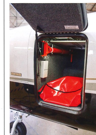
I det främre bagageutrymmet förvaras flygplanets bogserstång, pitotrörsskydd och andra kapell.
